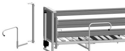
Visser la traverse sur le cadre du plan de couchage en utilisant les vis fournies.
