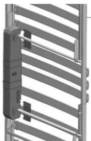
Glisser les plaques de couverture latéralement dans le dispositif de blocage du double entraînement
