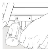
Faire glisser la barre de redressement dans la traverse de maintien, la mettre dans la position souhaitée et la visser fermement.
