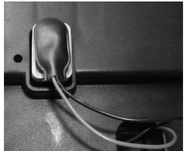
9-V-Blockbatterie für die Notabsenkung
